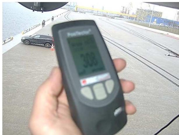
60.att. Tērauda sijas Nr. 8 aizsargpārklājuma bojājumi, siju krāsojuma biezuma mērījumi.
