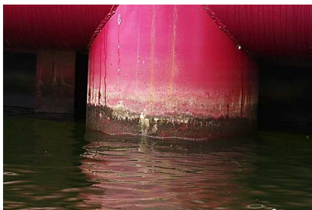
95.att. Kuģu atvairierīču aizsargpārklājuma bojājumi, korozija ūdens līmeņa mainīgajā zonā.
