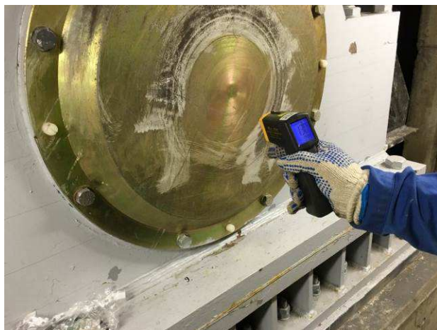
114.att. Galvenā elektromotora, rotācijas ass gultņa un laiduma konstrukcijas sijas temperatūras mērīšana to darbības laikā. Temperatūra balstu iekštelpā mērījumu laikā bija 9°C.
