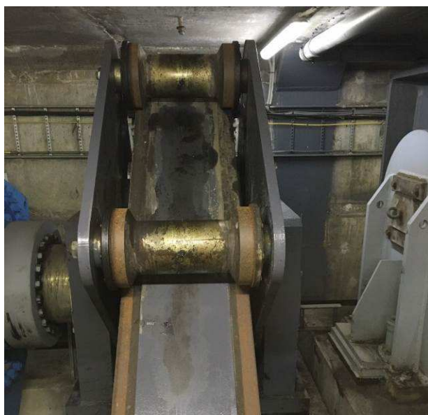
118.att. Zobrata vadotnes konstrukcija (ratiņi), balsts Nr. 5. Zobstieņa augšējā virsma, pa kuru iet zobrata rullīši, nav pietiekoši saeļļota.
