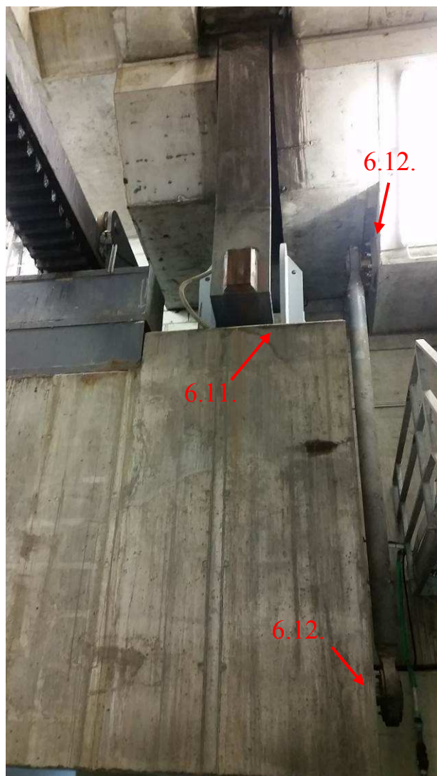
108.att. Pretsvara stabilizators (pretsvara piekāršanas ass mezgls). Savilces ar atbalstpunktiem (paralēlais stienis).
