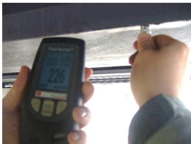
60.att. Tērauda sijas Nr. 8 aizsargpārklājuma bojājumi, siju krāsojuma biezuma mērījumi.
