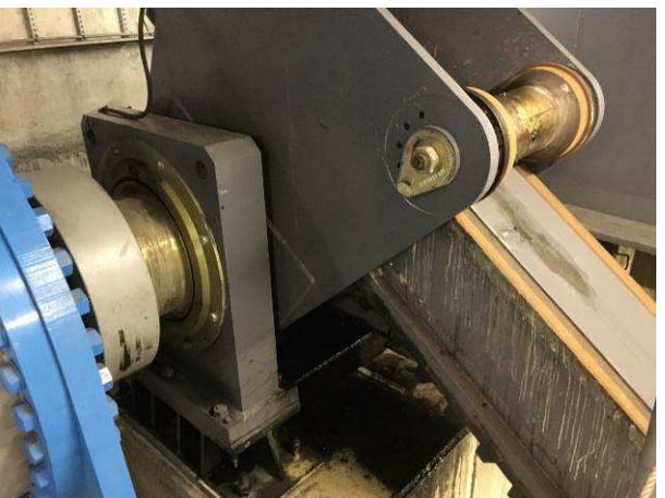
116.att. Zobrati, balsts Nr. 5. Betona konstrukcija ir noziesta ar eļļām.
