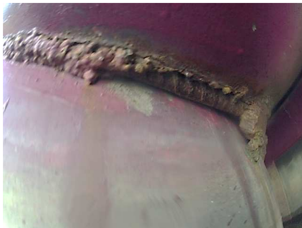
94.att. Tērauda konstrukciju metinājuma šuves defekts, korozija.
