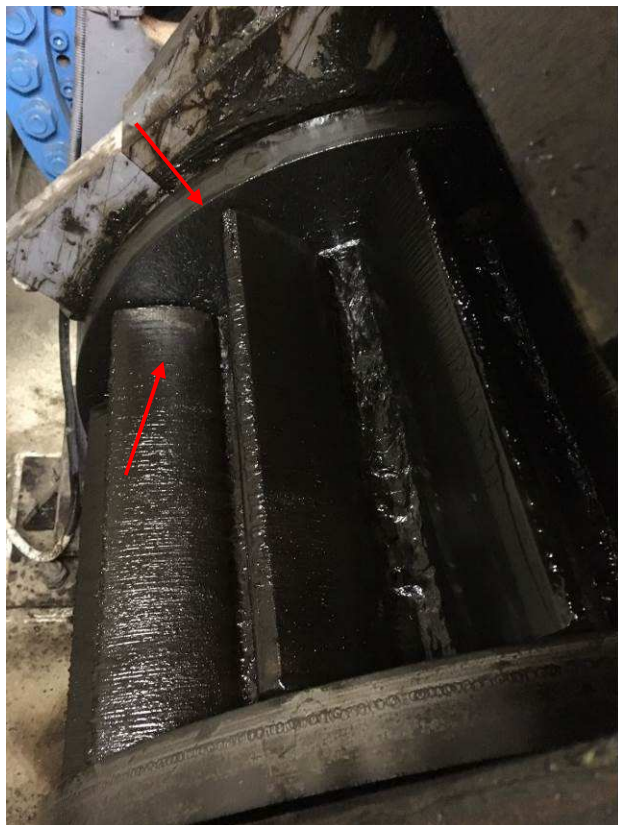
117.att. Zobrata mehānisms, balsts Nr. 5. Uz bildes ir redzams, ka smērviela uz mehānisma virsmas sadalās nevienmērīgi, kas norāda uz to, ka zobratam ir bojāts centrējums.
