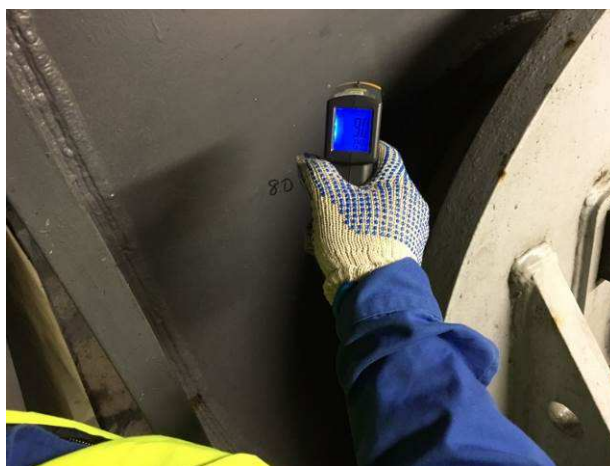
114.att. Galvenā elektromotora, rotācijas ass gultņa un laiduma konstrukcijas sijas temperatūras mērīšana to darbības laikā. Temperatūra balstu iekštelpā mērījumu laikā bija 9°C.
