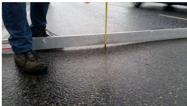
85.att. Risas asfaltbetona segumā.
