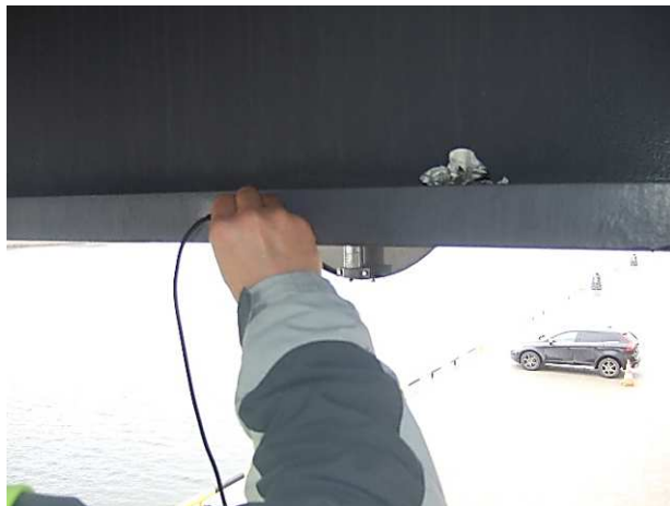
60.att. Tērauda sijas Nr. 8 aizsargpārklājuma bojājumi, siju krāsojuma biezuma mērījumi.
