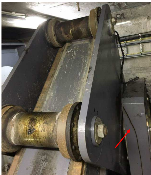
118.att. Zobrata vadotnes konstrukcija (ratiņi), balsts Nr. 5. Zobstieņa augšējā virsma, pa kuru iet zobrata rullīši, nav pietiekoši saeļļota.
