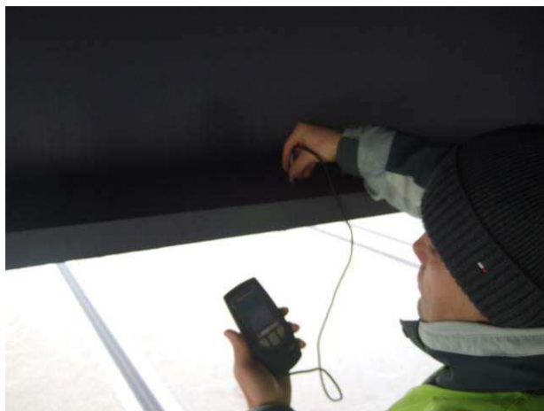
61.att. Tērauda sijas Nr. 9 aizsargpārklājuma mērījumu rādītāji.
